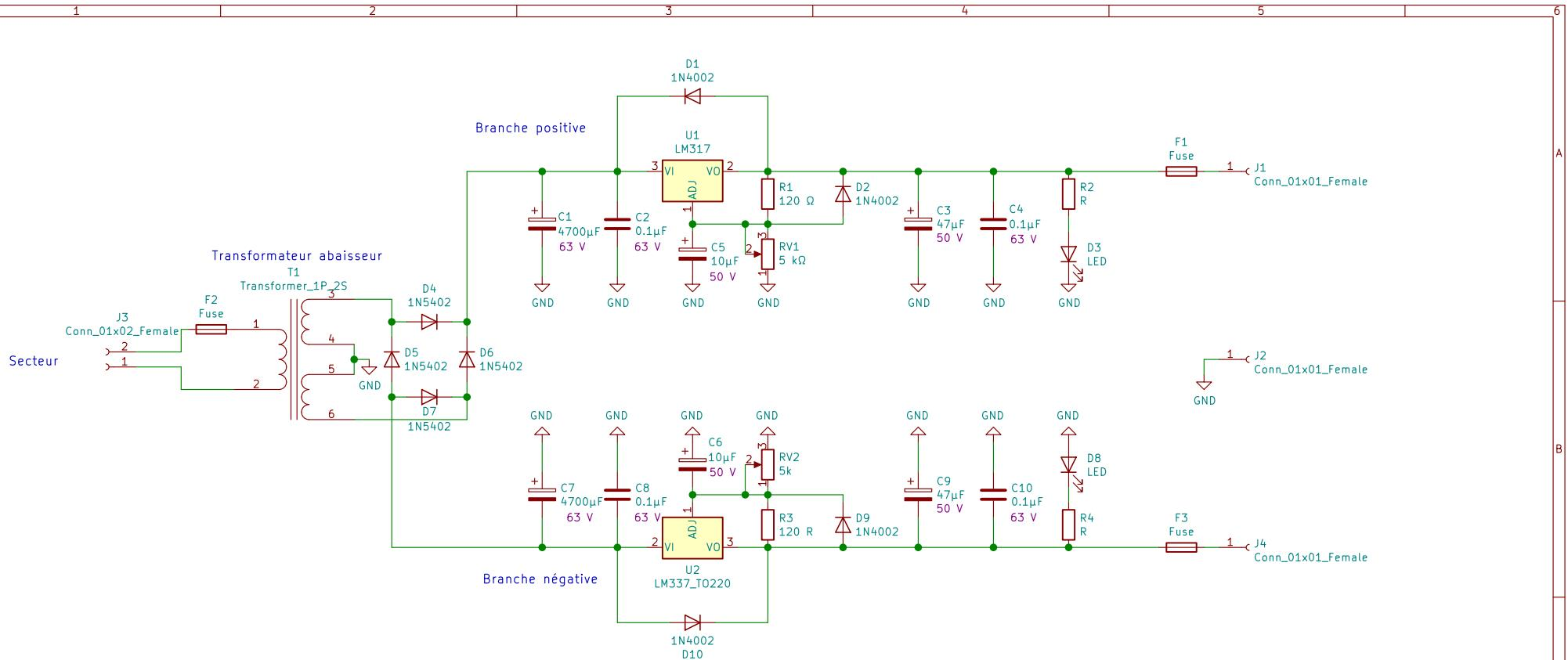
Deux fusibles F1 et F3 sont présent en sortie. Il ne sont pas vraiment nécessaire et me servent le plus souvent à installer un ampèremètre.
